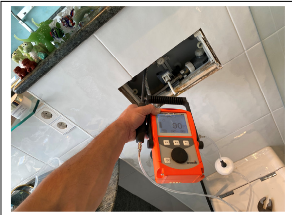
Bild 9 – Top 17 Georteter Rohrbruch in der Wand
